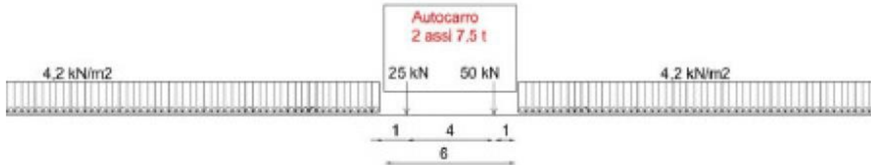
Figura 6.3.3– Possibile distribuzione di carico corrispondente ad un mezzo di 75 kN
