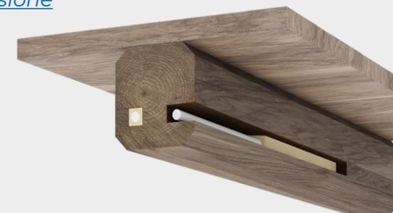
**9|D** - [Ricostruzione di testate ammalorate e di elementi strutturali in legno](#)
