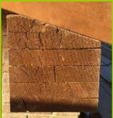
L' idoneità alla **classe di servizio 3** significa che il legno lamellare in ambiente umido non si scolla (incollato con colle di tipo I e spessore lamelle limitato a 35mm);
