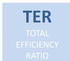
$$\text{TER} = (\text{Potenza Termica} + \text{Potenza Frigorifera}) / \text{Potenza Elettrica}$$
